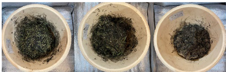
Рис. 2. Смесь осадка с хвоей, сеном и опилками
