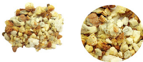
Рис. 3. Вспученный вермикулит, полученный в лабораторных условиях
